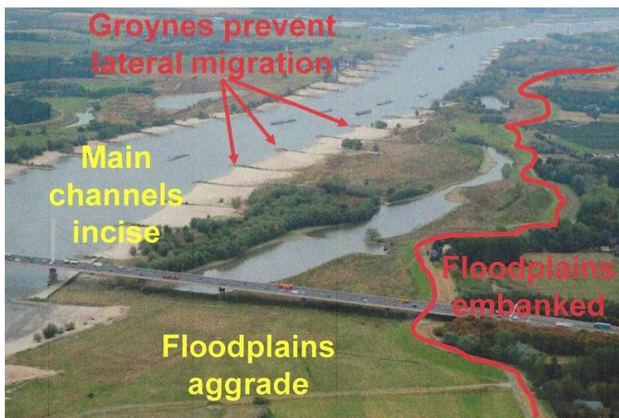
Figura 1 – Idromorfologia dei corridoi fluviali: alvei incisi e pianure alluvionali (aggragate e interrate) in presenza di pennelli che impediscono la migrazione laterale (da Buijse T., 2014, modif.)
